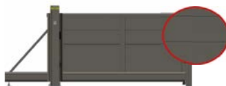
Glattblech mit Fräsung in Paneeloptik Tiefe waagrechte Fräsung: ca. 1,5 mm, nur einseitige Fräsung, im Rahmen eingebaut, Aluminium, 3 mm
