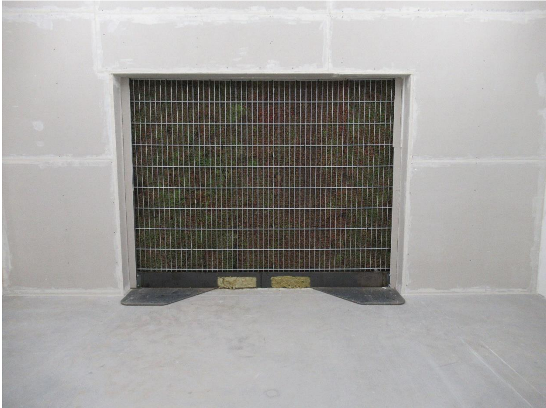
Bild 3: Ansicht Empfangsraum, Messung 1 (Pflanzen Gabione 1)
