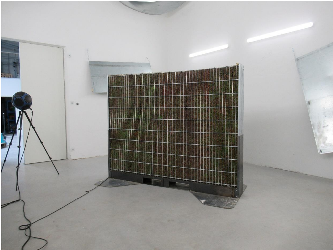
Bild 8: Ansicht Hallraum, Messung 2 (Pflanzen Gabione 1)
