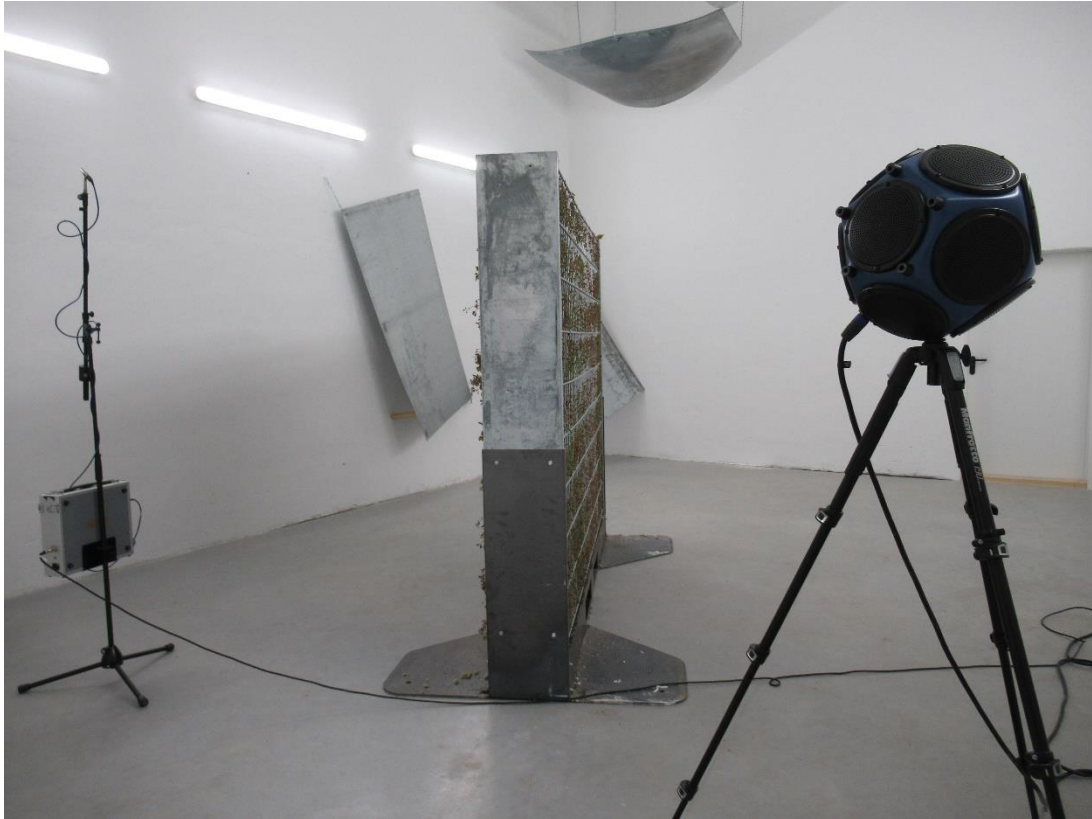
Bild 7: Ansicht Hallraum, Messung 2 (Pflanzen Gabione 1)
