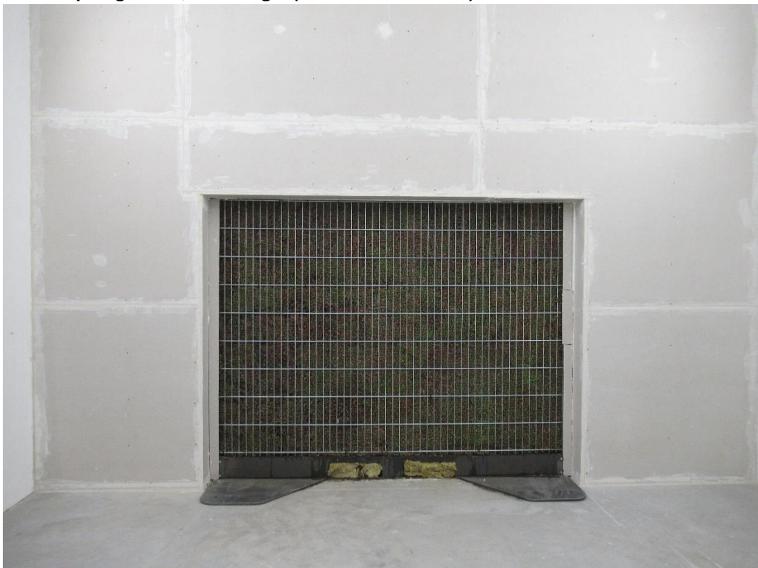
Bild 10: Ansicht Empfangsraum, Messung 3 (Pflanzen Gabione 2)
